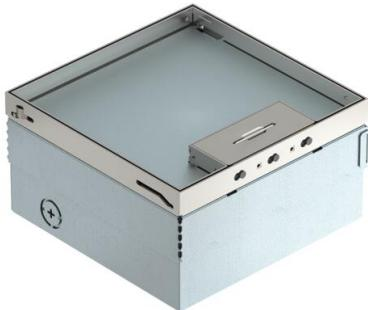
Caja de suelo cuadrada para cuatro mecanismos de tipo italiano para el montaje en suelos huecos y en pavimentos que precisan una limpieza en seco. La caja dispone de aberturas pretrouqueladas para la introducción de las canalizaciones (M25). Se puede ajustar la altura hasta el borde superior del revestimiento del suelo mediante los 4 soportes niveladores. Con rebaje para el pavimento en la tapa abatible de 15 mm. La profundidad mínima de montaje es de 110 mm y el margen de nivelación de + 30 mm.
