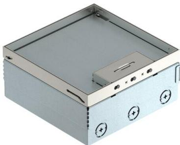
Depósito de suelo cuadrado para el uso en suelos huecos tratados en seco y suelos de mortero de interior. La carcasa empotrable dispone de entradas pre-troqueladas para tubo (M25). Con 2 soportes universales UT3 y una toma de tierra triple. Parte superior ajustable mediante 4 soportes de nivelación en el borde superior del revestimiento de suelo. La profundidad mínima de montaje es de 95 mm y el margen de nivelación de + 30 mm.
