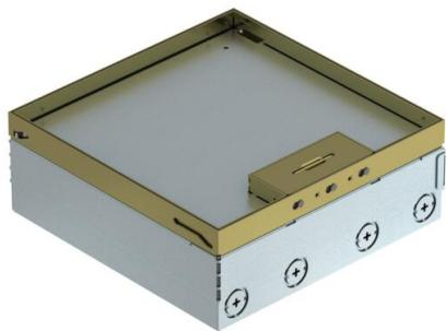
Depósito de suelo cuadrado para el uso en suelos huecos tratados en seco y suelos de mortero de interior. La carcasa empotrable dispone de entradas pre-troqueladas para tubo (M25). Con 3 soportes universales UT4 y dos tomas de tierra dobles. Parte superior ajustable mediante 4 soportes de nivelación en el borde superior del revestimiento de suelo. La profundidad mínima de montaje es de 95 mm y el margen de nivelación de + 30 mm.
