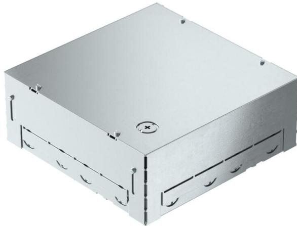
Carcasa de instalación empotrada de forma cuadrada para GES9-3 para suelos de pavimento continuo. Con entradas pretrouqueladas para la introducción de las canalizaciones (M25) desde los cuatro lados.
