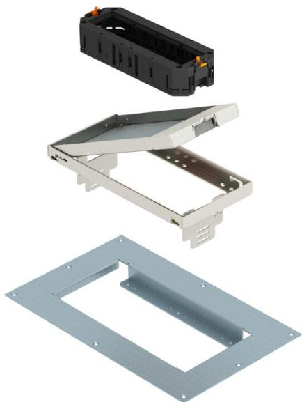
Conjunto de tapa y marco con altura regulable con todos los accesorios de sistema necesarios para el montaje directo en techos huecos en interiores. El volumen de suministro incluye una tapa de montaje y un soporte universal UT4/45 para cuatro mecanismos Modul 45® cada uno.
