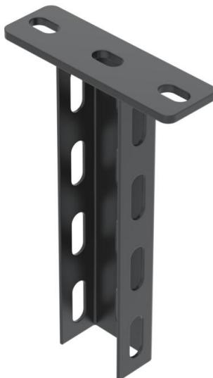
Perfil (perfil en U) de medidas 50 x 30 mm con cabeza soldada. Para fijación en techos de hormigón y vigas metálicas horizontales. Con revestimiento en polvo en negro intenso (RAL 9005). Con escuadras a partir de 400 mm de ancho o en caso de que la escuadra se instale en el extremo del perfil colgante, se recomienda utilizar la pieza distanciadora DSK 25.
