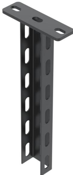
Perfil (perfil en U) de medidas 50 x 30 mm con cabeza soldada. Para fijación en techos de hormigón y vigas metálicas horizontales. Con revestimiento en polvo en negro intenso (RAL 9005). Con escuadras a partir de 400 mm de ancho o en caso de que la escuadra se instale en el extremo del perfil colgante, se recomienda utilizar la pieza distanciadora DSK 25.
