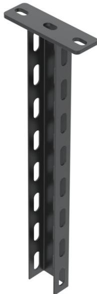
Perfil (perfil en U) de medidas 50 x 30 mm con cabeza soldada. Para fijación en techos de hormigón y vigas metálicas horizontales. Con revestimiento en polvo en negro intenso (RAL 9005). Con escuadras a partir de 400 mm de ancho o en caso de que la escuadra se instale en el extremo del perfil colgante, se recomienda utilizar la pieza distanciadora DSK 25.
