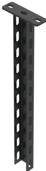
Perfil (perfil en U) de medidas 50 x 30 mm con cabeza soldada. Para fijación en techos de hormigón y vigas metálicas horizontales. Con revestimiento en polvo en negro intenso (RAL 9005). Con escuadras a partir de 400 mm de ancho o en caso de que la escuadra se instale en el extremo del perfil colgante, se recomienda utilizar la pieza distanciadora DSK 25.
