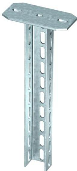
Soporte colgante (perfil en U) de medidas 70 x 50 mm con cabeza soldada. Para fijación en techos de hormigón y vigas metálicas horizontales. Con escuadras a partir de 400 mm de ancho o en caso de que la escuadra se instale en el extremo del perfil colgante, se recomienda utilizar la pieza distanciadora DSK 61.
