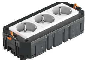
El soporte universal UTC3 listo para conectar tiene tres tomas de corriente con toma de tierra 33° preinstaladas con 16 A. Adecuado para los cables de conexión VL y para su uso en las cajas portamecanismos del tamaño nominal 2, 4, R4, 6 y R7.
