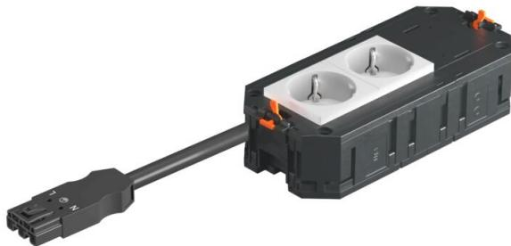
El soporte universal UTC3 listo para conectar tiene 2 tomas de corriente con toma de tierra 33° preinstaladas en blanco con 16 A y una tapa ciega para el montaje posterior de un mecanismo de la serie Modul45 o Modul 45connect. Adequado para los cables de conexión VL y para su uso en las cajas portamecanismos del tamaño nominal 2, 4, R4, 6 y R7.
