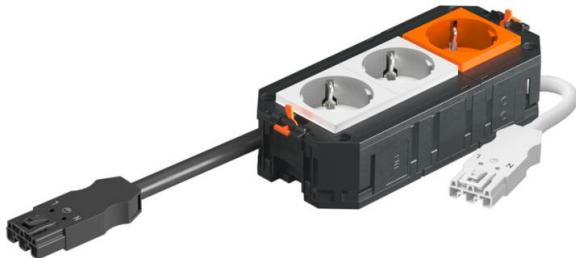
El soporte universal UTC3 listo para conectar tiene 2 tomas de corriente con toma de tierra 33° preinstaladas en blanco con 16 A y una toma de corriente con toma de tierra 33° preinstalada en naranja con 16 A. Adecuado para los cables de conexión VL y para su uso en las cajas portamecanismos del tamaño nominal 2, 4, R4, 6 y R7.
