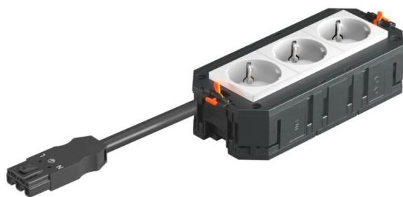
El soporte universal UTC3 listo para conectar tiene 3 tomas de corriente con toma de tierra 33° preinstaladas en blanco con 16 A. Adecuado para los cables de conexión VL y para su uso en las cajas portamecanismos del tamaño nominal 2, 4, R4, 6 y R7. Línea de conexión de PVC con conector, 3 polos, tipo WINSTA® MIDI.
