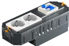
Soporte universal Connect UTC4 listo para conectar con sistema de conectores WAGO WINSTA® MIDI. Adecuado para los cables de conexión VL-WIN y para su uso en las cajas portamecanismos del tamaño nominal R7, 9 y R9. El soporte universal UTC4 FI listo para conectar tiene 2 tomas de corriente con toma de tierra protegidas con FI/LS. Cableado interno de 2,5 mm<sup>2</sup>. Tenga en cuenta los requisitos de conexión (y también la selectividad).
