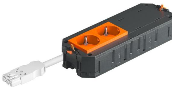
El soporte universal UTC4 listo para conectar tiene 2 tomas de corriente con toma de tierra 33° preinstaladas con 16 A y 2 tapas ciegas para el montaje posterior de 2 mecanismos de la Modul45. Adecuado para los cables de conexión VL y para su uso en las cajas portamecanismos del tamaño nominal R7, R9 y 9.
