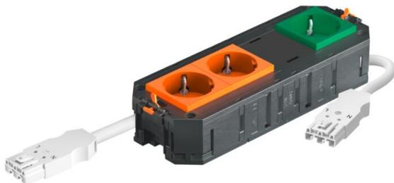
El soporte universal UTC4 listo para conectar tiene 2 tomas de corriente con toma de tierra 33° preinstaladas en naranja y una toma de corriente con toma de tierra 33° preinstalada en verde menta, y una tapa ciega para el montaje posterior de un mecanismo de la serie Modul45 o Modul 45connect, 250 V~ 16 A.
