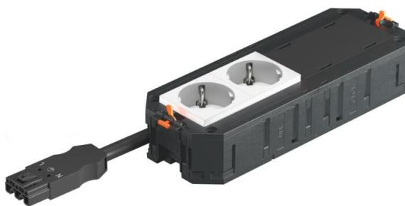
El soporte universal UTC4 listo para conectar tiene 2 tomas de corriente con toma de tierra 33° preinstaladas en blanco y 2 tapas ciegas para el montaje posterior de 2 mecanismos de la Modul45. Adecuado para los cables de conexión VL y para su uso en las cajas portamecanismos del tamaño nominal R7, R9 y 9.
