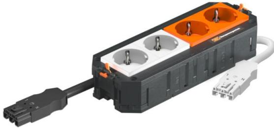
El soporte universal UTC4 listo para conectar tiene 2 tomas de corriente con toma de tierra 33° preinstaladas en blanco y 2 tomas de corriente con toma de tierra 33° preinstaladas en naranja (con módulo de protección contra sobretensiones tipo 3 según DIN EN 61643-11), 250 V~ 16 A.
