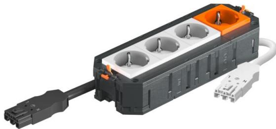
El soporte universal UTC4 listo para conectar tiene 3 tomas de corriente con toma de tierra 33° preinstaladas en blanco y una toma de corriente con toma de tierra 33° preinstalada en naranja, 250 V~ 16 A. Con línea de conexión sin halógenos. Adecuado para los cables de conexión VL y para su uso en las cajas portamecanismos del tamaño nominal R7, R9 y 9.
