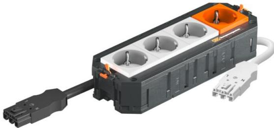
El soporte universal UTC4 listo para conectar tiene 3 tomas de corriente con toma de tierra 33° preinstaladas en blanco y una toma de corriente con toma de tierra 33° preinstalada en naranja (con módulo de protección contra sobretensiones tipo 3 según DIN EN 61643-11), 250 V~ 16 A.
