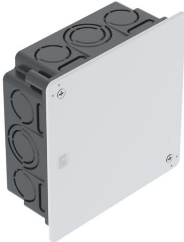
Caja de empotrar para conexiones, uso en mampostería con una profundidad de instalación de al menos 45 mm. Con tapa y tornillos para tapa (15 mm) El borde de la tapa descansa en posición plana, la superficie está rallada.
