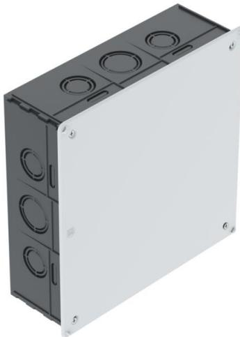
Caja de empotrar para conexiones, uso en mampostería con una profundidad de instalación de al menos 65 mm Con tapa y tornillos para tapa (15 mm) El borde de la tapa descansa en posición plana, la superficie está rallada.
