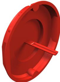
La tapa de señalización protege el interior: los huecos y las cabezas de los tornillos, al enlucir. Las cerdas de marcado permiten encontrar fácilmente de nuevo las cajas después de realizar el enlucido. La tapa de señalización se puede utilizar varias veces. Despues del enlucido, presionar simplemente la tapa hacia dentro de la caja y retirar la tapa de señalización.
