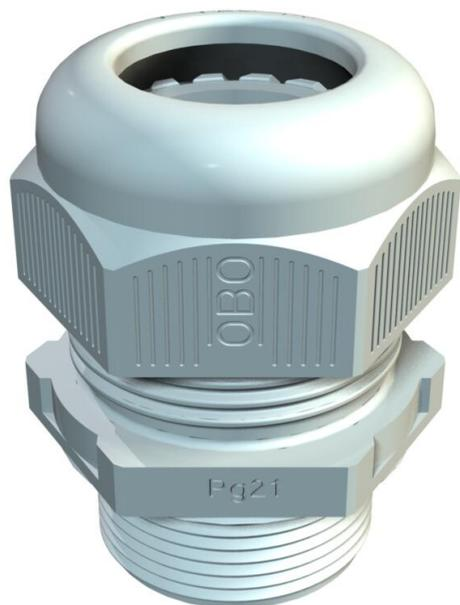
Prensaestopas con rosca de conexión métrica PG de tipo con tuerca de capuchón, para cajas de derivación, carcasa, cajas de distribución en sector privado e industrial. Con descarga de tracción y labio de sellado integrado, probado según DIN EN 62444. Clase de protección IP68. Se puede utilizar entre -20 °C y +65 °C.
