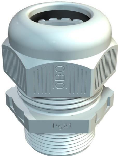
Prensaestopas con rosca de conexión métrica PG de tipo con tuerca de capuchón, para cajas de derivación, carcasa, cajas de distribución en sector privado e industrial. Con descarga de tracción y lábio de sellado integrado , probado según DIN EN 62444. Clase de protección IP68. Se puede utilizar entre -20 °C y +65 °C.
