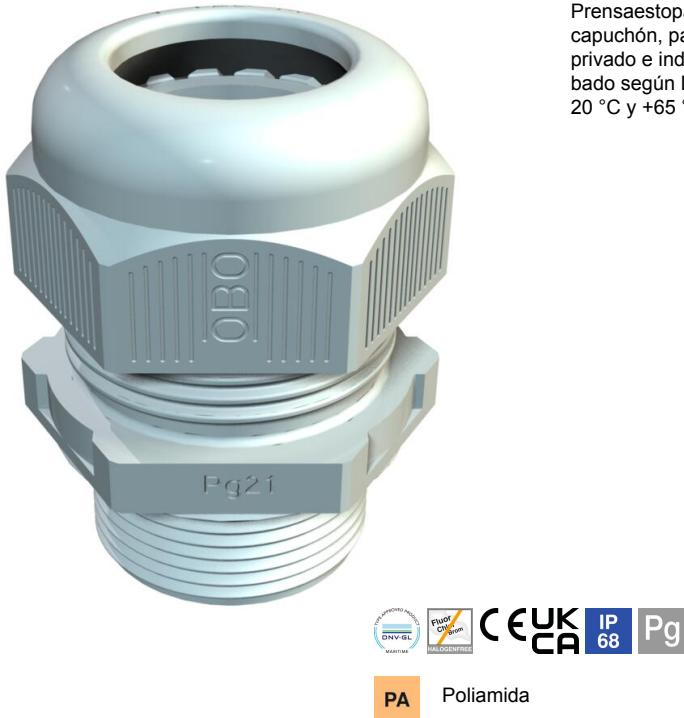
Prensaestopas con rosca de conexión métrica PG de tipo con tuerca de capuchón, para cajas de derivación, carcasa, cajas de distribución en sector privado e industrial. Con descarga de tracción y lábio de sellado integrado , probado según DIN EN 62444. Clase de protección IP68. Se puede utilizar entre -20 °C y +65 °C.
