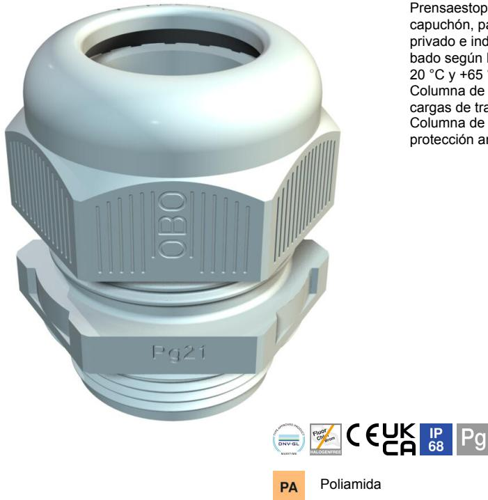
Prensaestopas con rosca de conexión métrica PG de tipo con tuerca de capuchón, para cajas de derivación, carcasa, cajas de distribución en sector privado e industrial. Con descarga de tracción y lábio de sellado integrado, probado según DIN EN 62444. Clase de protección IP68. Se puede utilizar entre -20 °C y +65 °C.
