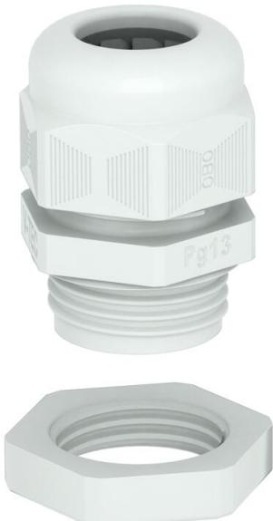
Prensaestopas con rosca de conexión métrica PG de tipo con tuerca de capuchón, para cajas de derivación, carcasa, cajas de distribución en sector privado e industrial. Con descarga de tracción y lábio de sellado integrado, probado según DIN EN 62444. Clase de protección IP68. Se puede utilizar entre -20 °C y +65 °C. Incluida contratuerca.
