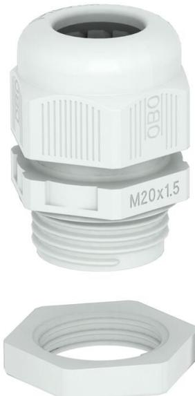
Prensaestopas con rosca de conexión métrica de tipo con tuerca de capuchón, para cajas de derivación, carcasa, armarios de distribución en sector privado e industrial. Con descarga de tracción y labio de sellado integrado , probado según DIN EN 62444. Clase de protección IP68. Se puede utilizar entre -20 °C y +65 °C. Incluida contratuerca.
