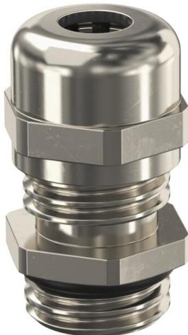
Prensaestopas robusto con rosca de conexión métrica según IEC 423 de tipo con tuerca de capuchón para situaciones donde se exige una elevada estanqueidad. Descarga de tracción, protección contra la torsión y estanqueidad a lo largo de toda la zona de apriete. Empaquetadura de neopreno. Bloque de terminales de poliamida. Con junta de sellado premontada en rosca métrica, probado VDE según DIN EN 50262, grado de protección IP68 a 5 bar/1 h, rango de temperatura entre -20 y +100 °C.
