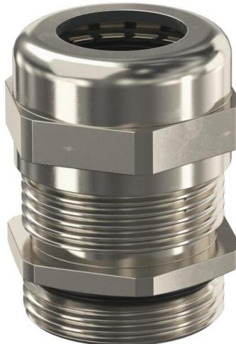
Prensaestopas robusto con rosca de conexión métrica según IEC 423 de tipo con tuerca de capuchón para situaciones donde se exige una elevada estanqueidad. Descarga de tracción, protección contra la torsión y estanqueidad a lo largo de toda la zona de apriete. Empaquetadura de neopreno. Bloque de terminales de poliamida. Con junta de sellado premontada en rosca métrica, probado VDE según DIN EN 50262, grado de protección IP68 a 5 bar/1 h, rango de temperatura entre -20 y +100 °C.
