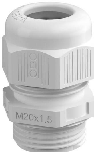
Prensaestopas con rosca de conexión métrica de tipo con tuerca de capuchón, para cajas de derivación, carcasa, armarios de distribución en sector privado e industrial. Con descarga de tracción y labio de sellado integrado , probado según DIN EN 62444. Clase de protección IP68. Se puede utilizar entre -20 °C y +65 °C.
