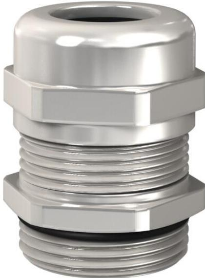
Prensaestopas CEM robusto con rosca de conexión métrica según IEC 423 de tipo con tuerca de capuchón para situaciones donde se exige una elevada estanqueidad. Descarga de tracción, protección contra la torsión y estanqueidad a lo largo de toda la zona de apriete. Empaquetadura de neopreno. Con junta tórica premontada en la rosca de conexión, con homologación VDE según EN 50262, grado de protección IP68 con 5 bar/1 h.
