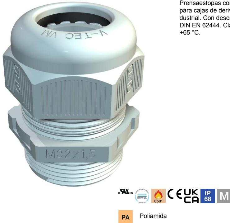
Prensaestopas con rosca de conexión métrica de tipo con tuerca de capuchón, para cajas de derivación, carcasa, cajas de distribución en sector privado e industrial. Con descarga de tracción y labio de sellado integrado, probado según DIN EN 62444. Clase de protección IP68. Se puede utilizar entre -20 °C y +65 °C.
