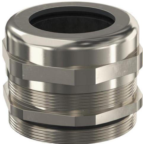
Prensaestopas robusto con rosca de conexión métrica según IEC 423 de tipo con tuerca de capuchón para situaciones donde se exige una elevada estanqueidad. Descarga de tracción, protección contra la torsión y estanqueidad a lo largo de toda la zona de apriete. Empaquetadura de neopreno. Bloque de terminales de poliamida. Con junta de sellado premontada en rosca métrica, probado VDE según DIN EN 50262, grado de protección IP68 a 5 bar/1 h, rango de temperatura entre -20 y +100 °C.
