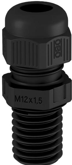
Prensaestopas con rosca de conexión métrica de tipo con tuerca de capuchón, para cajas de derivación, carcasa, armarios de distribución en sector privado e industrial. Con descarga de tracción y labio de sellado integrado , probado según DIN EN 62444. Clase de protección IP68. Se puede utilizar entre -20 °C y +65 °C.
