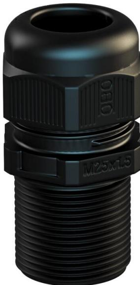
Prensaestopas con rosca de conexión métrica de tipo con tuerca de capuchón, para cajas de derivación, carcasa, armarios de distribución en sector privado e industrial. Con descarga de tracción y labio de sellado integrado, probado según DIN EN 62444. Clase de protección IP68. Se puede utilizar entre -20 °C y +65 °C.
