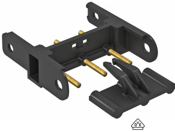
Adaptador de conexión para la unión de tomas de corriente STD-D0C/STD-D3C o STD-F0C/STD-F3C.
