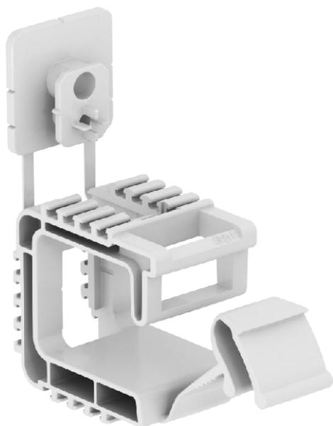
Abrazadera para haces de cables para aplicaciones generales con orificios de fijación 6 mm Ø, adecuada para el montaje sobre paredes y techos. El elemento de fijación inyectado puede fijarse con tacos o con pistolas de clavos de gas. La distancia recomendada entre las fijaciones con abrazaderas completamente ocupadas es de 50-60 cm.
