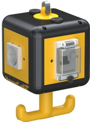
La torreta colgante VH-4 con protección descentralizada activa directamente el interruptor FI/LS en caso de sobrecorriente/corriente residual (16 A/30 mA). Se puede reconectar directamente en la unidad de suministro.
