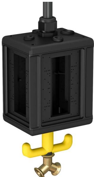
Caja vacía con 1 m de tubo 1/2" y conexión para manguera de aire comprimido 13 x 3,5 mm y distribuidor de 2 vías 1/2". Con tuerca cáncamo y ganchos de agarre, para montaje de equipos eléctricos, con elemento separador incluido. Sin cubiertas protectoras. Para el abastecimiento de lugares de trabajo en zonas húmedas. Grado de protección: IP 44.
