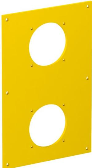
Tapa con dos orificios de 45 mm Ø para el montaje de dos tomas de ampliación (tipo ASD-...) con carril de fijación de 38 mm, incluidos 8 tornillos para fijar el mecanismo.
