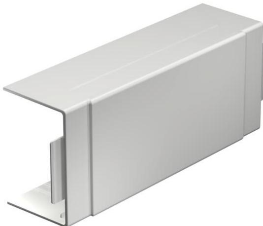
Derivación en T para cambio de dirección de los canales WDKH libres de halógenos. La pieza preformada está previamente perforada en el lateral para la conexión de diferentes secciones de canal. Por lo general, los accesorios se diseñan como piezas que cubren.
