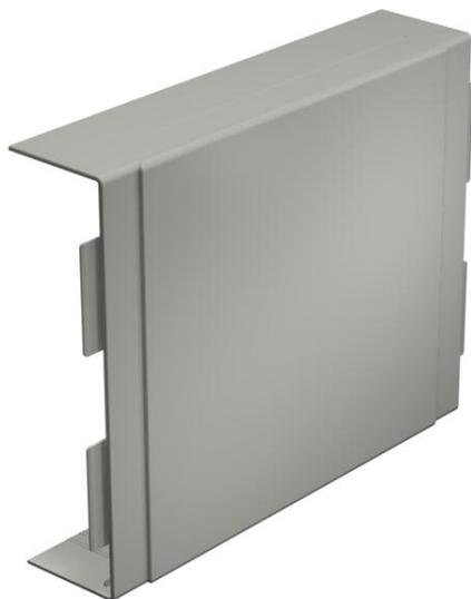
Derivación en T para modificar la dirección de los canales WDK. La pieza prefabricada está previamente perforada en el lateral para la conexión de diferentes secciones de canal.
