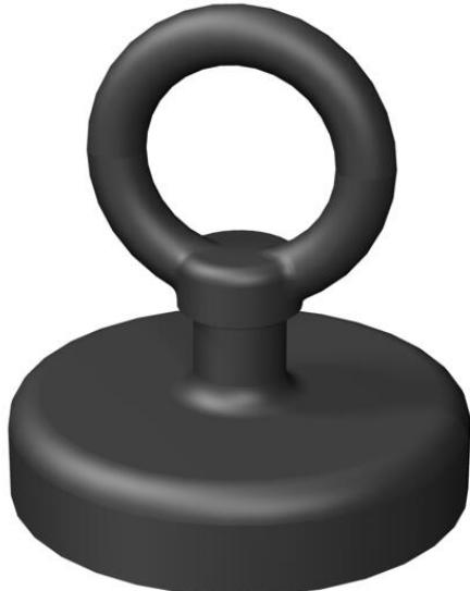
Elevador magnético WZ 28 1028 para levantar tapas de cajas y canales con re-vestimientos de moqueta con un grosor de 3-10 mm. Fuerza de adherencia: 1.300 N
