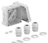
Caja de derivación con regleta de conexión para la conexión de cables y líneas en zonas interiores y zonas exteriores. Forma cuadrada con entradas ciegas. Apropiado para el montaje en pared y techo con la posibilidad de fijación exterior, interior o montaje en las esquinas. Particularmente resistente a los impactos con IK09. Tapa con cierre rápido, precintable. Fabricada con materiales libres de halógenos y resistentes a los rayos UV.
