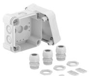
Caja de derivación para la conexión de cables y líneas en zonas interiores y zonas exteriores. Forma cuadrada con entradas ciegas. Apropiado para el montaje en pared y techo con la posibilidad de fijación exterior, interior o montaje en las esquinas. Particularmente resistente a los impactos con IK09. Tapa con cierre rápido, precintable. Fabricada con materiales libres de halógenos y resistentes a los rayos UV.
