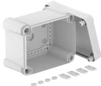
Caja de derivación para la conexión de cables y líneas en zonas interiores y zonas exteriores. Forma rectangular sin entradas. Apropiado para el montaje en pared y techo con la posibilidad de fijación exterior, interior o montaje en las esquinas. Particularmente resistente a los impactos con IK09. Tapa con cierre rápido, precintable. Fabricada con materiales libres de halógenos y resistentes a los rayos UV.
