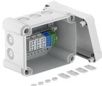
Caja de derivación para la conexión de cables y líneas en zonas interiores y zonas exteriores. Forma rectangular con entradas ciegas. Apropiado para el montaje en pared y techo con la posibilidad de fijación exterior, interior o montaje en las esquinas. Particularmente resistente a los impactos con IK09. Tapa con cierre rápido, precintable. Fabricada con materiales libres de halógenos y resistentes a los rayos UV.
